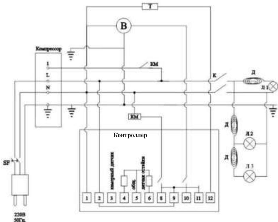
Рис. 3. Электрическая схема оборудования
