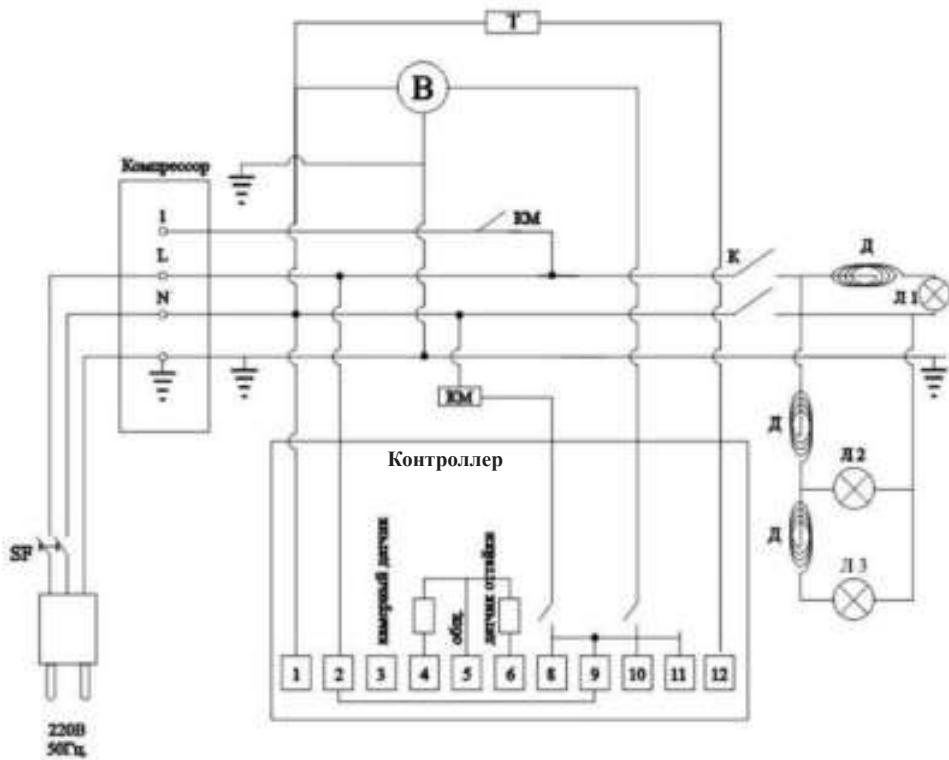
Рис. 3. Электрическая схема оборудования
