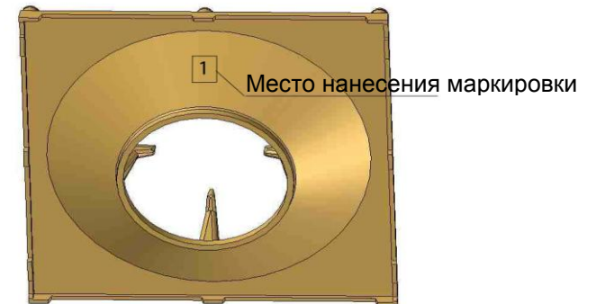
Рис12. Схема установки и маркировка газовых решеток. Маркированная часть решетки должна быть направлена в сторону кранов горелок
