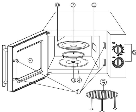
1. Система предохранительного закрытия двери
