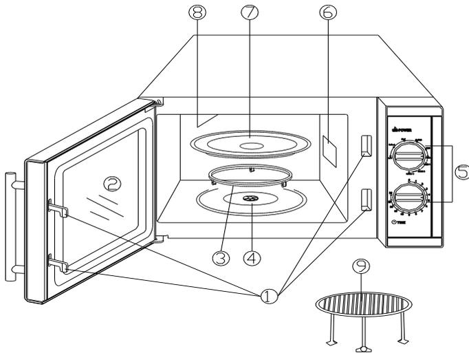
**Рис.1. Основные узлы оборудования**
