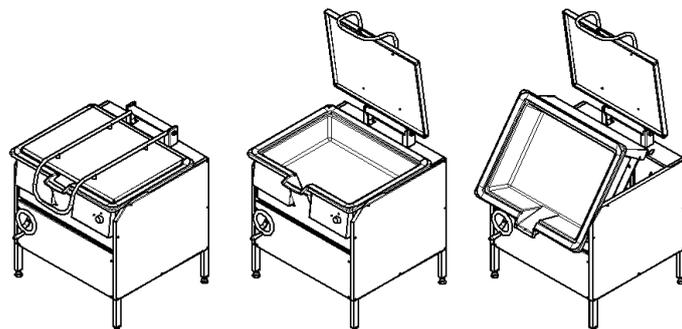
Чаша накрывается откидной крышкой, снабжённой пружинным механизмом, который обеспечивает легкий подъем и фиксацию крышки в открытом положении. Крышка препятствует разбрызгиванию продукта в процессе приготовления, уменьшает теплопотери и предотвращает попадание конденсата на наружные поверхности сковороды.
