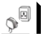
Электропитание аппарата осуществляется от сети переменного тока напряжением 220 В, частотой 50 Гц. Розетка должна иметь надёжное заземление.
