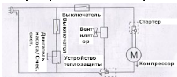
Принципиальная электросхема дозатора-сокооохладителя с одинарным контейнером для напитков JD-1.
