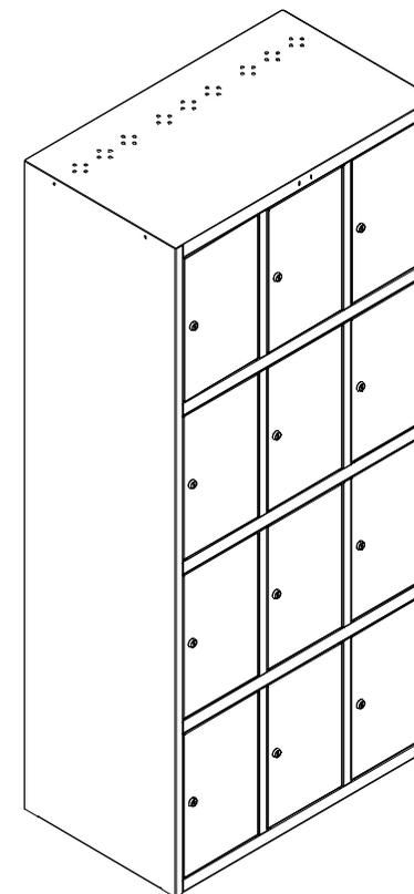
Конструкция шкафа предусматривает сборку или на саморезах, или на заклепках. В случае сбора на заклепках, они устанавливаются вместо саморезов, а также дополнительно в местах, указанных на рисунках.
