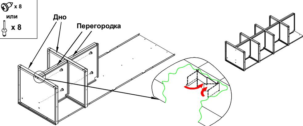
**2** Ввиду технологических особенностей производства, один из выступов перегородки изначально загнут на 90°
