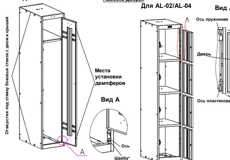
1. Для AL-01: оси с подпружиненным штоком вставляются в отверстия дна и крышки (при необходимости очистить отверстия от краски) (Для AL-02/AL-04: Навеску дверей необходимо начинать с верхней дверцы, вверх ставится пружинная ось, а в низ - пластиковая ось, потом на шток пластиковой оси устанавливается дверца и защелкивается пружинный шток
