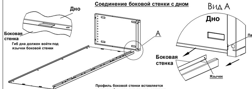
Профиль боковой стенки вставляется в ответный вырез дна локера, согласно схеме
