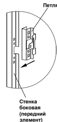
**ВАЖНО!** При наличии вертикального люфта двери, необходимо устранить его, путем подкладывания регулировочной шайбы(входит в комплектацию) под ось.
