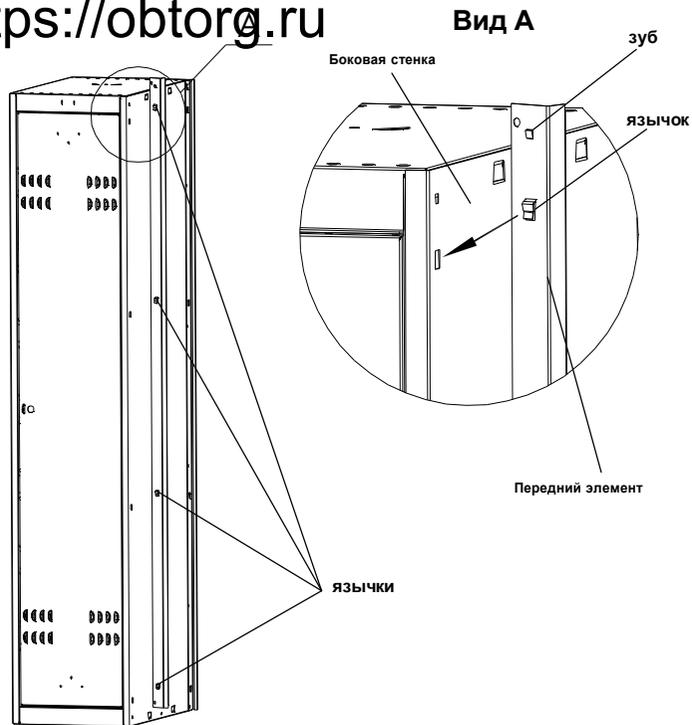
**Порядок установки элементов приставной секции**
