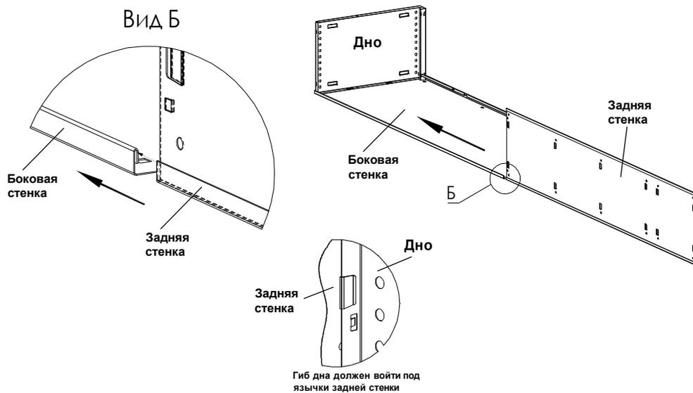
Стыковка первой боковины с задней стенкой и дном производится в горизонтальном положении (на боковине), стыковка второй боковины - на задней стенке.
