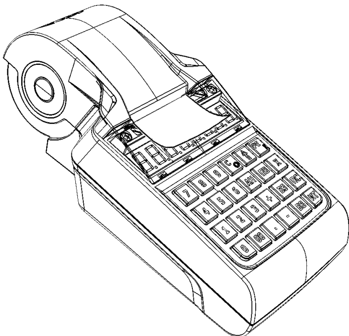
Рисунок 8. Закрытие крышки изделия
