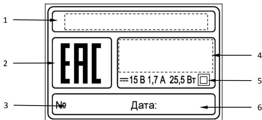
Рисунок 2 – Шильдик ККТ «ОРИОН-100Ф».
