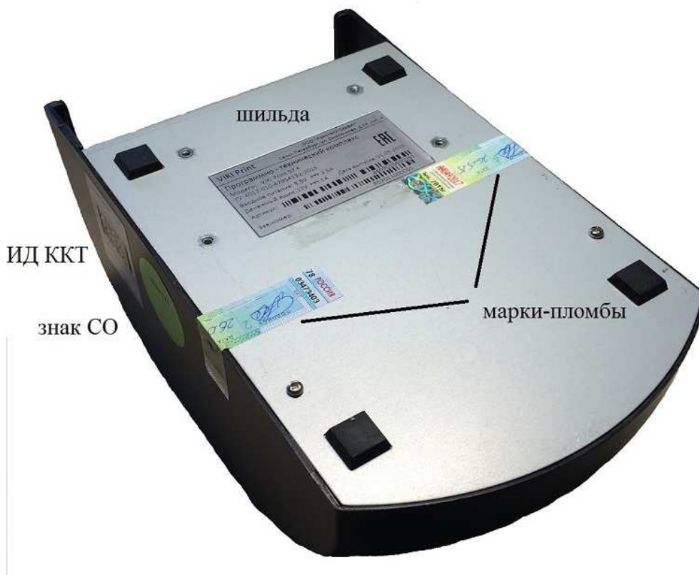
Рис.2 Места пломбировки и маркировки ПТК
