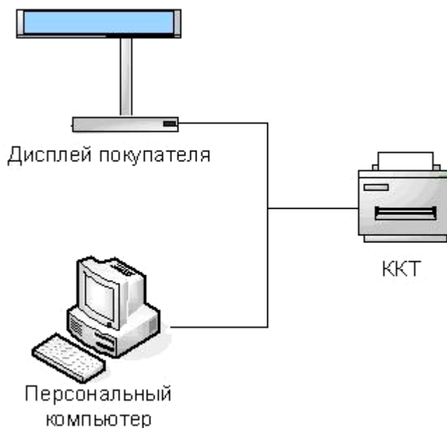
Рисунок 3. Подключение управляющих устройств к ККТ
