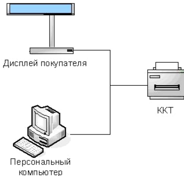
Рисунок 2. Подключение управляющих устройств к ККТ
