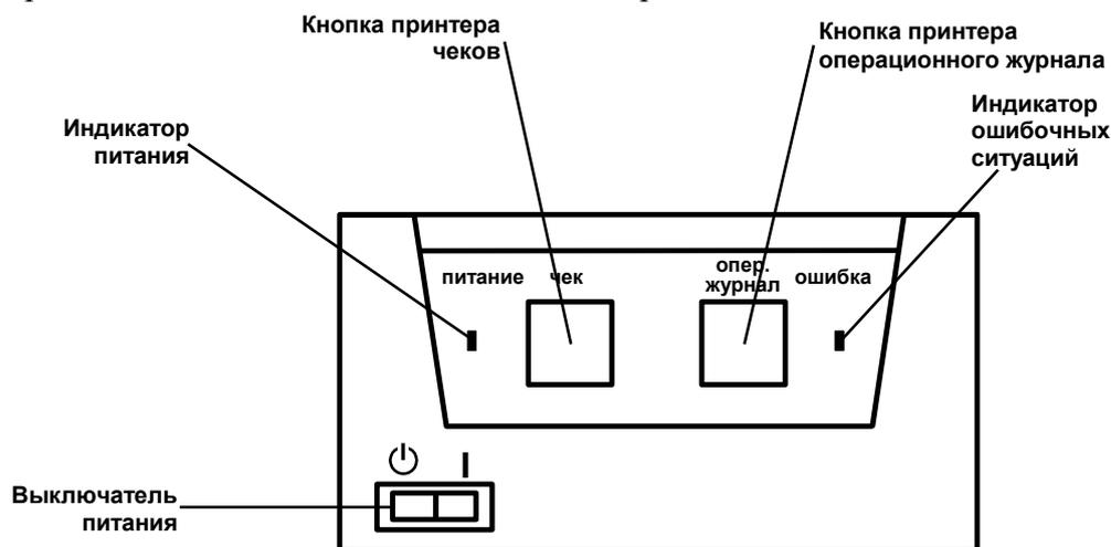
**Выключатель питания** служит для включения/выключения питания ККМ.
