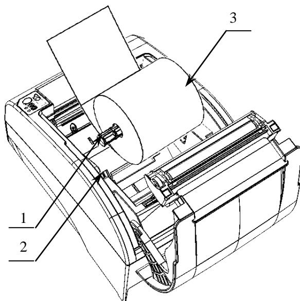
Рисунок 7. Заправка бумаги при вертикальной установке ПД
