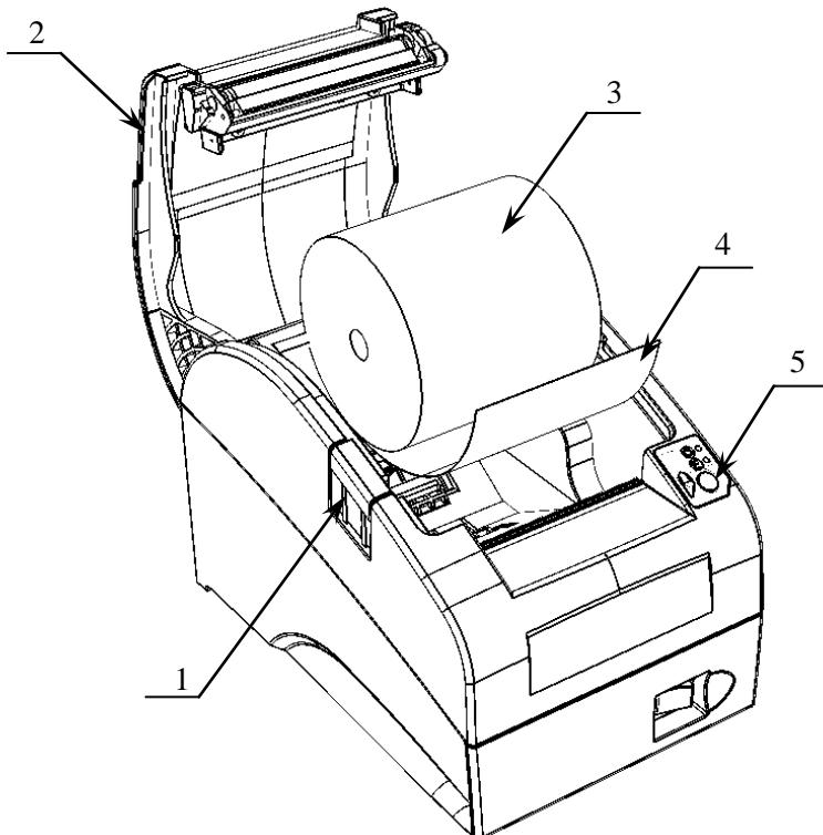
Рисунок 6. Заправка бумаги при горизонтальной установке ПД
