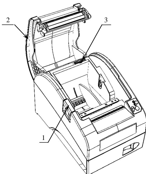
Рисунок 4. Расположение SD карты в корпусе ПД
