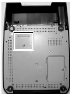
Затем откройте крышку отделения для батареи UPS и снимите с нее крышку отсека дисплея покупателя. Результат должен быть такой же, как показано на картинках справа и внизу.
