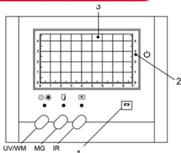
**ВНИМАНИЕ!** Для включения экрана ЭЛТ и лампы дневного света необходимо положить банкноту на рабочий стол Рис.1 поз. 4, перекрыв датчик автоматического включения. Время стабилизации изображения на экране ЭЛТ 6 сек.
