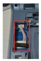
В отсеке для ФН расположен шлейф для подключения ФН к системной плате ККТ.
