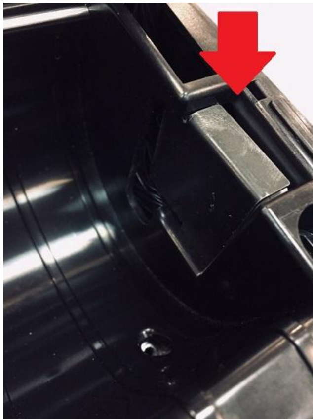
Фото 3. ККТ с установленной защитной крышкой для ФН.
