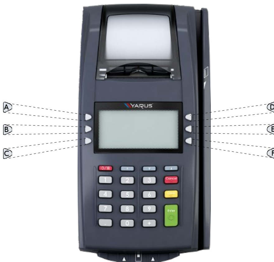
Рис. 3.1. Условные обозначения боковых кнопок С2100.
