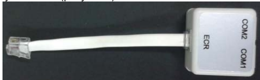
Рисунок 2 – Дополнительный модуль для доступа ко второму порту RS-232C
