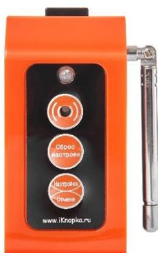
бюджетное компактное решение, предназначенное для оповещения о вызове с беспроводной кнопки (особенно в рамках программы "Доступная среда"). После поступления вызова приемник на протяжении 15 секунд подает звуковой сигнал, который может быть прерван при помощи нажатия кнопки "Отмена". Поддерживает до 10 кнопок вызова. Работает от электросети.
