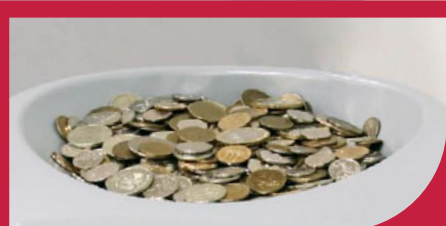
Загрузочный бункер вмещает до 2000 монет
